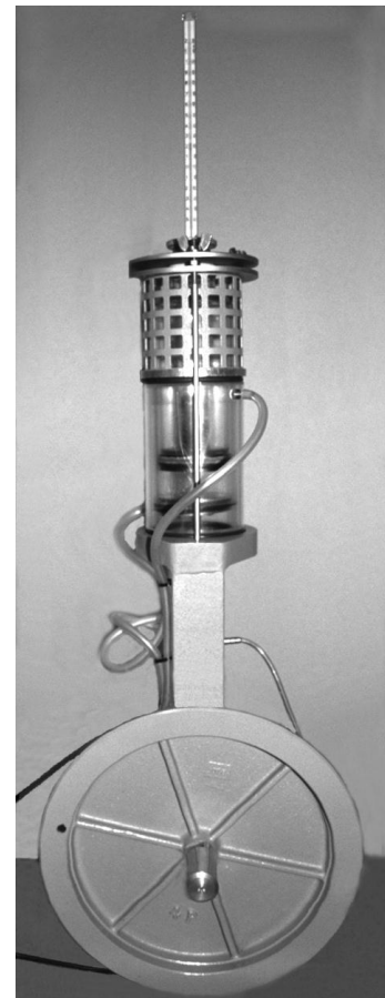
Figur 7 Svänghjulet på Stirlingmotorn kan drivas runt av en elektrisk motor. Varje gång kretsprocessen genomlöps tar arbetsgasen upp värme som sedan antingen avges till kylvattnet eller till den del där termometern sitter.
